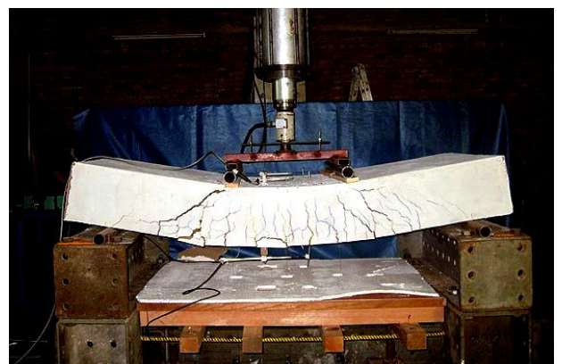
Fig. 12. Flexural failure of slab. Testing in Universidad Católica. Perú.
